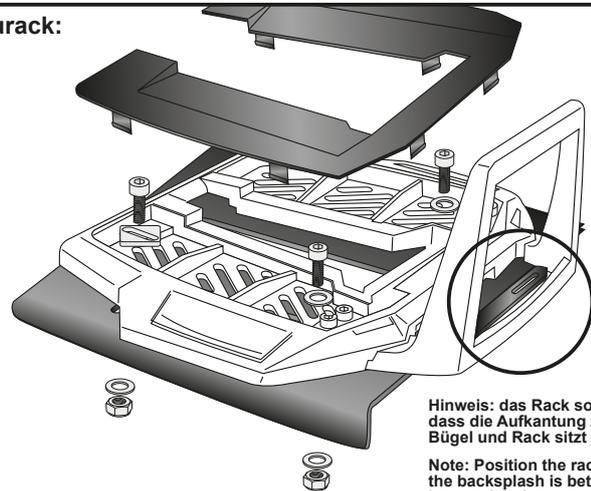
Hinweis: das Rack so positionieren, dass die Aufkantung zwischen Bügel und Rack sitzt
